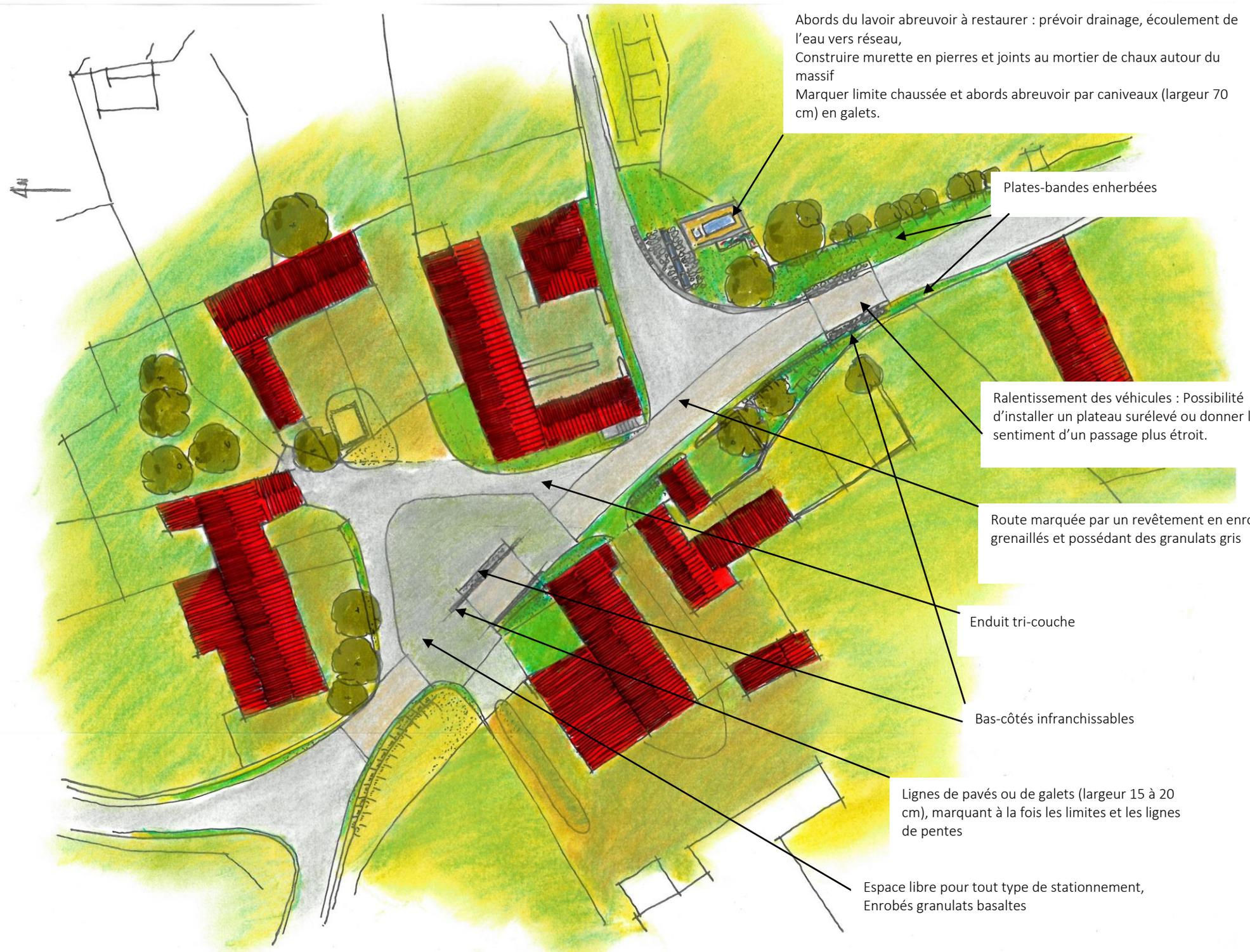
Abords du lavoir abreuvoir à restaurer : prévoir drainage, écoulement de l'eau vers réseau,
