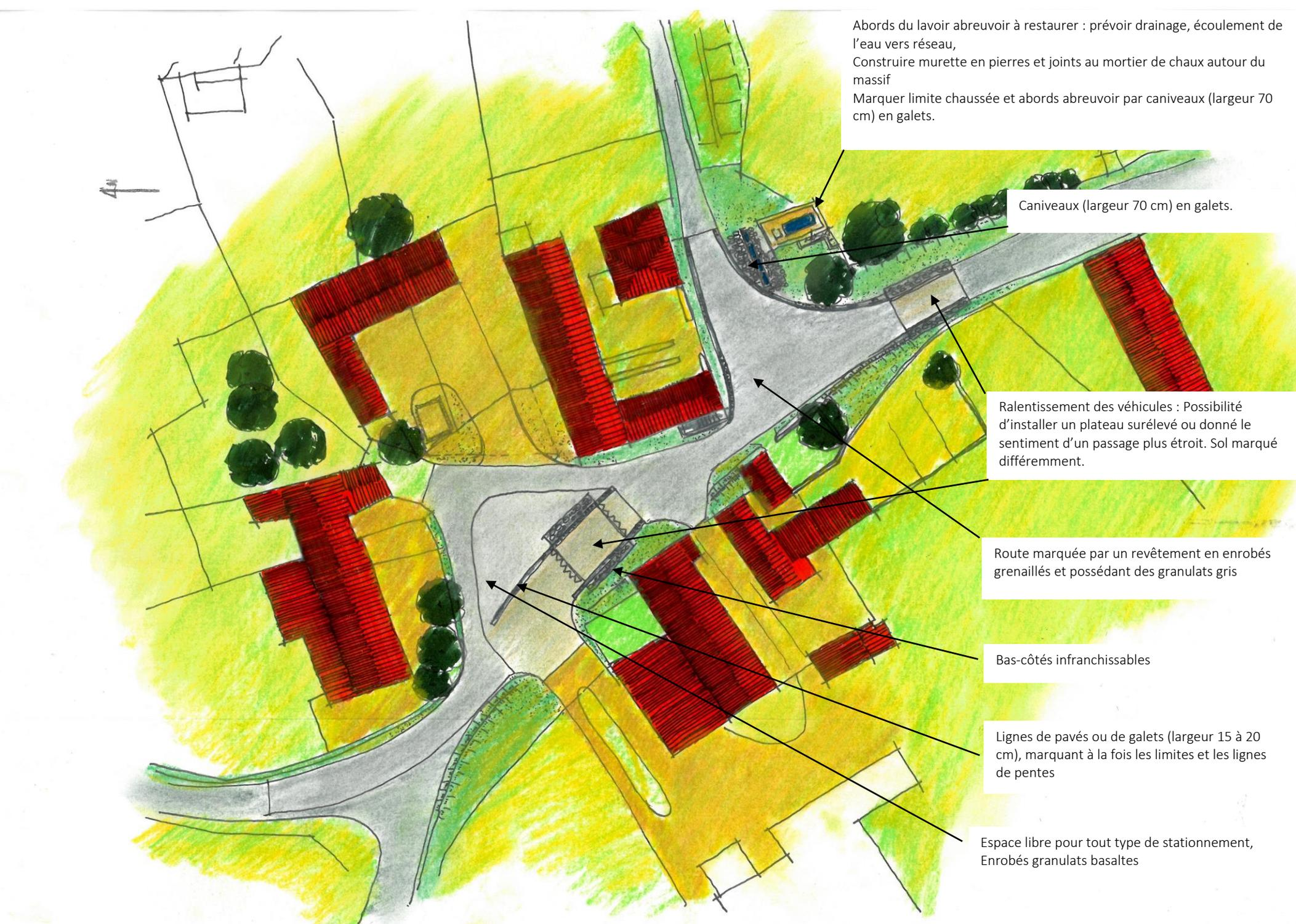
Abords du lavoir abreuvoir à restaurer : prévoir drainage, écoulement de l'eau vers réseau,
