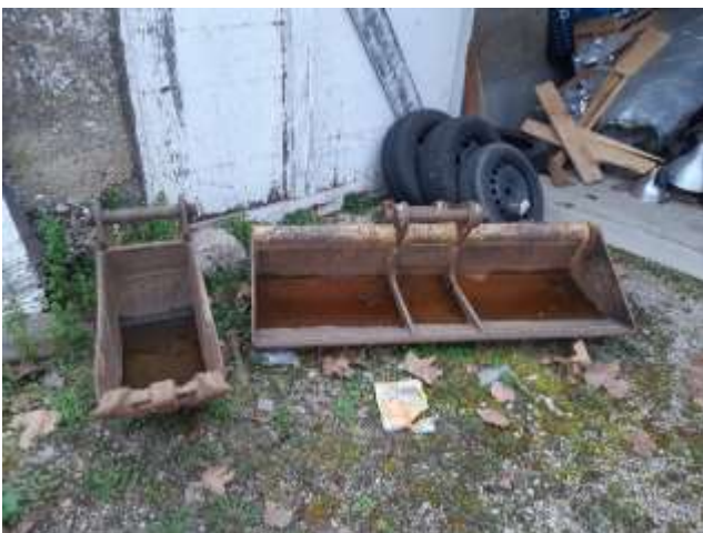
Godets engin de chantier
